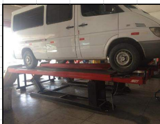
Vista Lateral da Rampa
