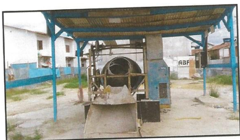
Foto 3: BETONEIRA 600L C/MOTOR TRIFÁSICO DE 7,5CV E C/CARREGADOR. FAB. MENEGOTTI.
